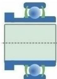
Подшипник шариковый **LK 206-2F+H 2306 (FKL)** со сферическим наружным кольцом, с конусным отверстием и с закрепительной втулкой
